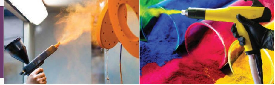
**◀ دهان الطلاء الكهروستاتيكي مع مقاومة التآكل**
