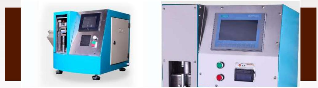
**◀ جهاز اختبار بلين**
