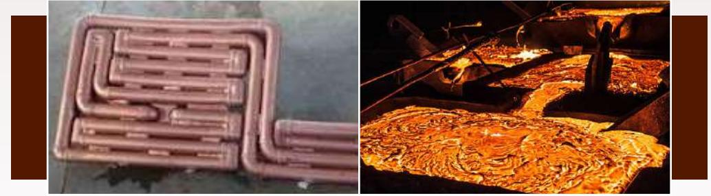
**لوحة نحاسية للإذابة في أفران القوس الكهربائي**
